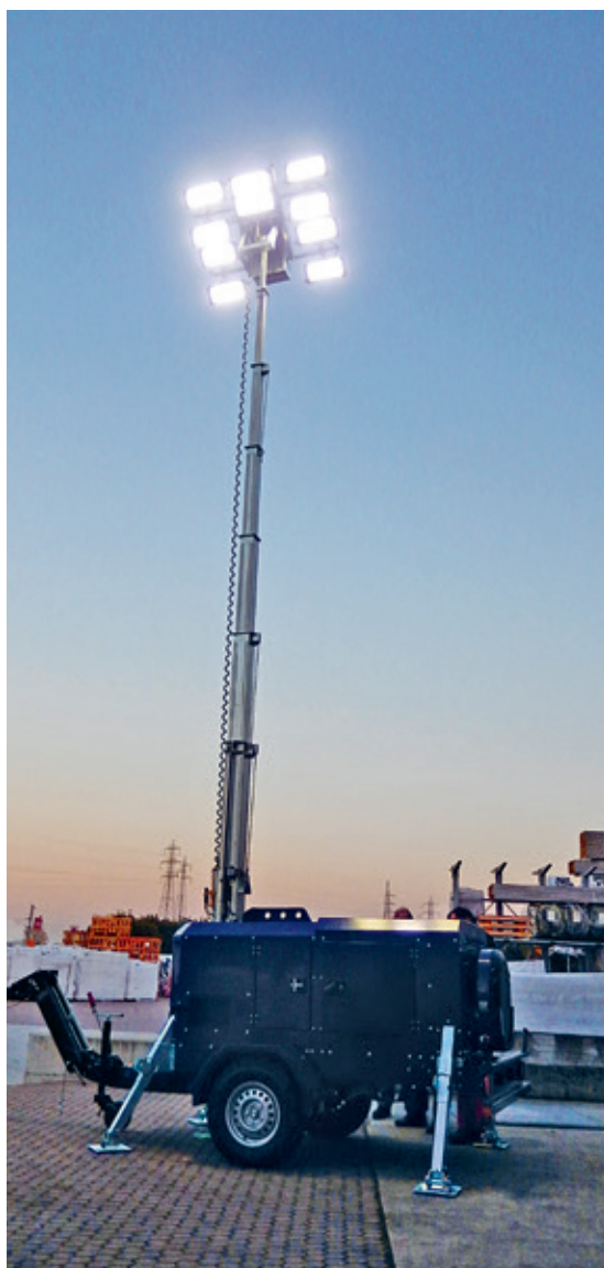
Ein mobiler Lichtmastanhänger dieser Art macht in Tunesien jetzt die Nacht zum Tag.
